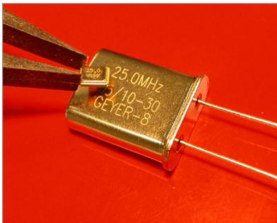
*Bild 1: Ein moderner SMD-Quarz über einem Quarz der älteren Bauform „HC-49“ (3,2 x 2,5 mm bzw. 13 x 10 mm). Das Volumen für die Unterbringung der Quarzscheibe ist sehr viel kleiner. Das hat Folgen für die elektrischen Eigenschaften, die beachtet werden müssen.
