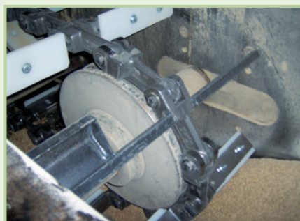
Cadena 4B142HA Con Paletas de UHMW y Cangilones de Retorno - Extremo Conducido
