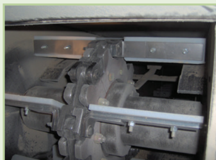
Cadena 4B142HA con Paletas UHMW apernadas a Aletas tipo "T" - Extremo Motriz
