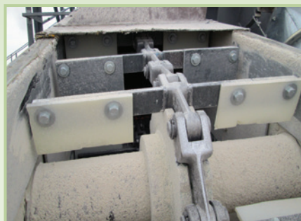
4B142HA Cadena con Paletas de UHMW Transportando Maíz
