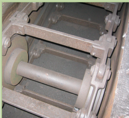
4B142DNA Aplicación con Cadena Doble Transportando Cenizas
