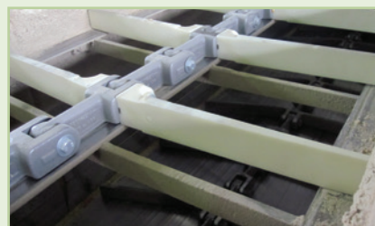
Aplicación de Granos utilizando Cadena 4B142BHA Bolt 'N' Go™
