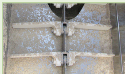
Molinera utilizando Cadena 4B142BNA Bolt 'N' Go™
