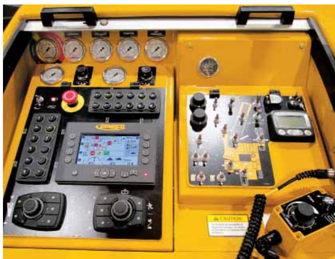
Bétonnière à coffrages glissants pour bordures et caniveaux GT-3600 avec le système de commande G+.
