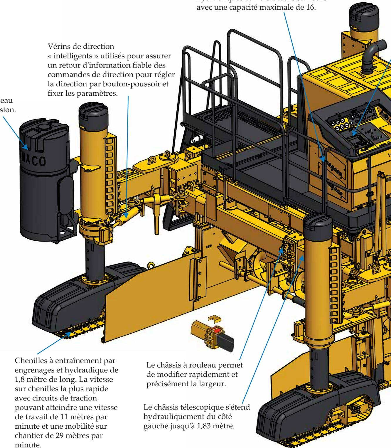
Chenilles à entraînement par engrenages et hydraulique de 1,8 mètre de long. La vitesse sur chenilles la plus rapide avec circuits de traction pouvant atteindre une vitesse de travail de 11 mètres par minute et une mobilité sur chantier de 29 mètres par minute.
