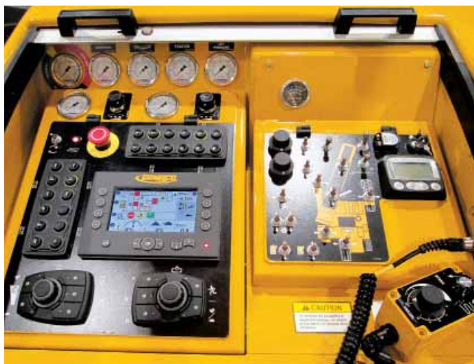
Pavimentadora de encofrado deslizante GT-3600 de cuatro orugas de GOMACO con sistema de control G+ para bordillos y cunetas.
