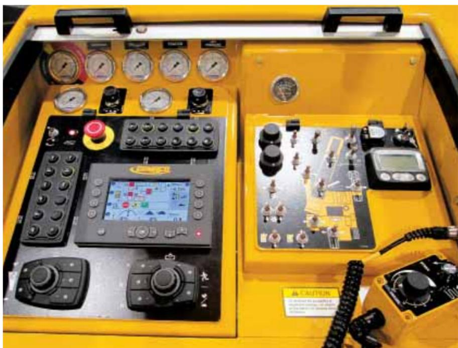
Gleitschalungsfertiger GT-3600 für Bordkanten und Rinnsteine mit dem G+ Steuersystem.
