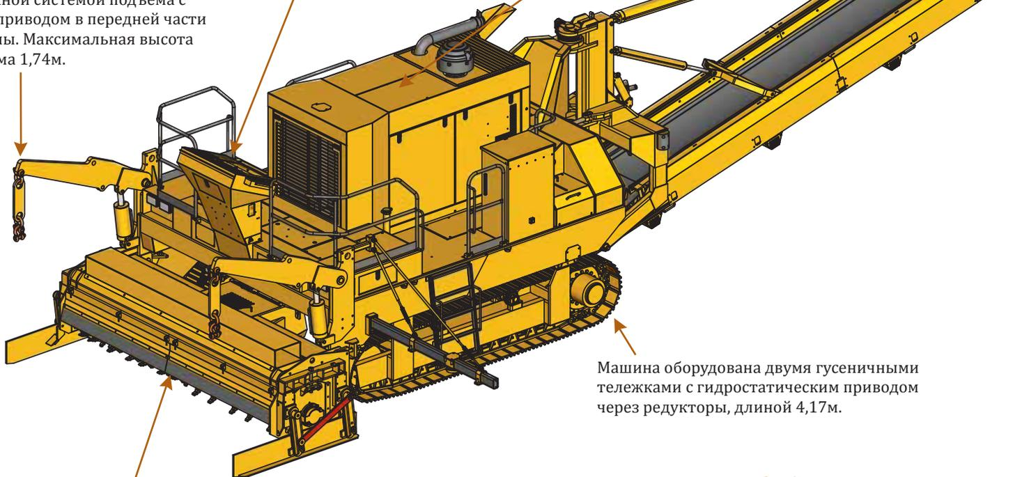
Машина оборудована двумя гусеничными тележками с гидростатическим приводом через редукторы, длиной 4,17м.
