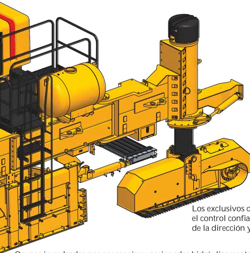
Los exclusivos cilindros de dirección "inteligentes" se usan para el control confiable de la dirección, permitiendo la configuración de la dirección y la fijación de parámetros por botones.
