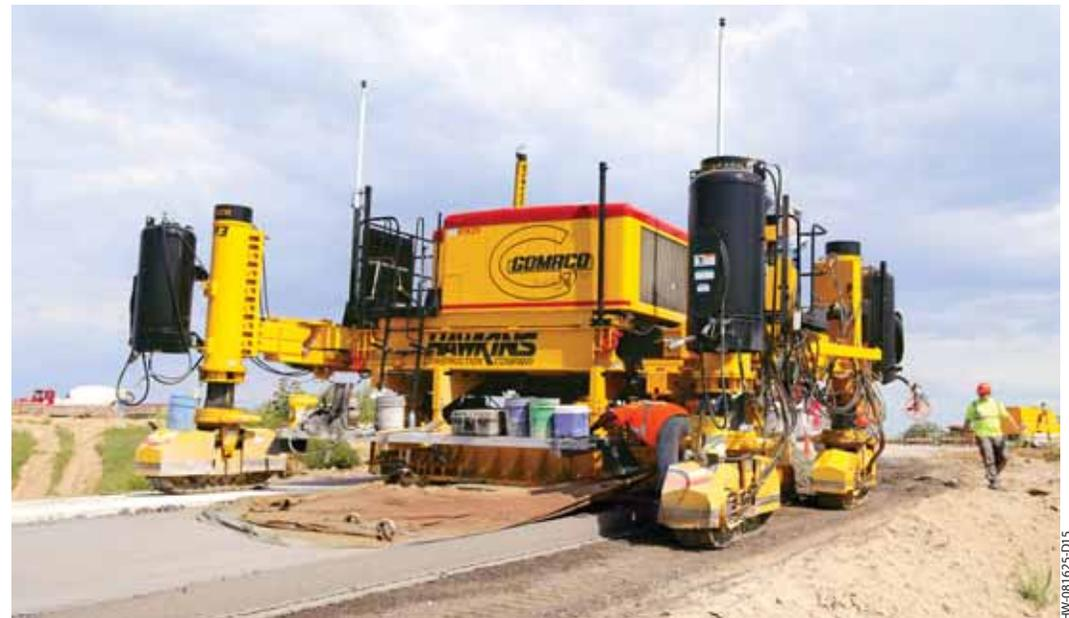
Der GP3 mit einem 3D-Maschinenleitsystem fertigt ein 2,44 m Bankett mit Jutetuch-Deckenschluss auf einer Autobahnauffahrt.
