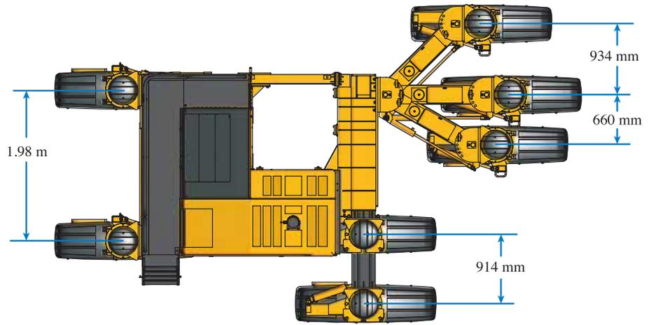
Le positionnement toutes chenilles (ATP) permet de positionner les colonnes pour augmenter la stabilité et éviter les obstacles. Colonne avant droite télescopique, colonne avant gauche à pivotement hydraulique et colonne arrière à glissement hydraulique pour le positionnement.
