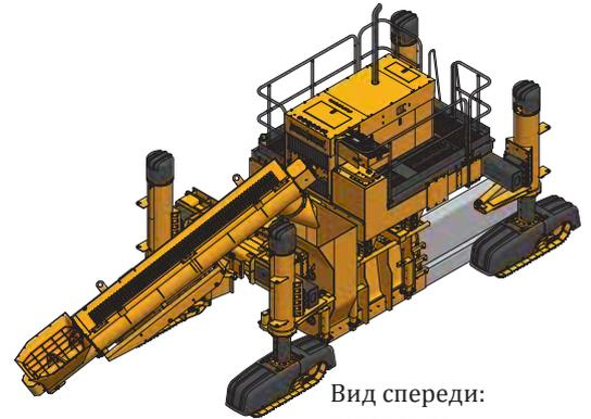
Вид спереди: установка под машиной, при укладке с левой стороны максимальная высота барьера 1 метр.
