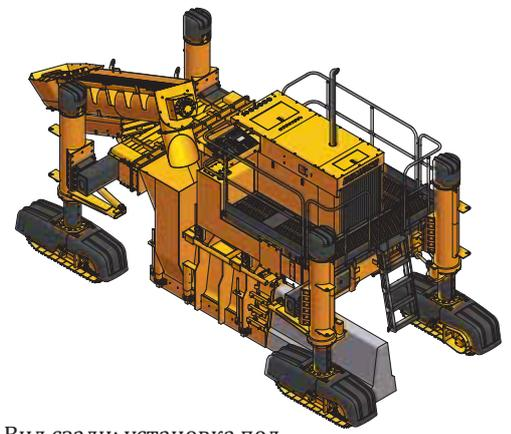
Вид сзади: установка под машиной, при установке слева максимальная высота барьера 1 метр. Скользящие формы можно также установить и с правой стороны под машиной.
