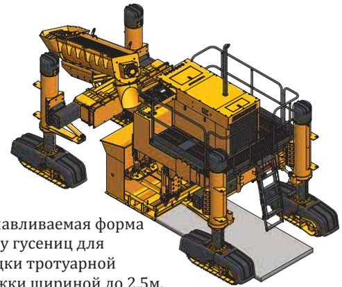
Устанавливаемая форма между гусениц для укладки тротуарной дорожки шириной до 2,5м.
