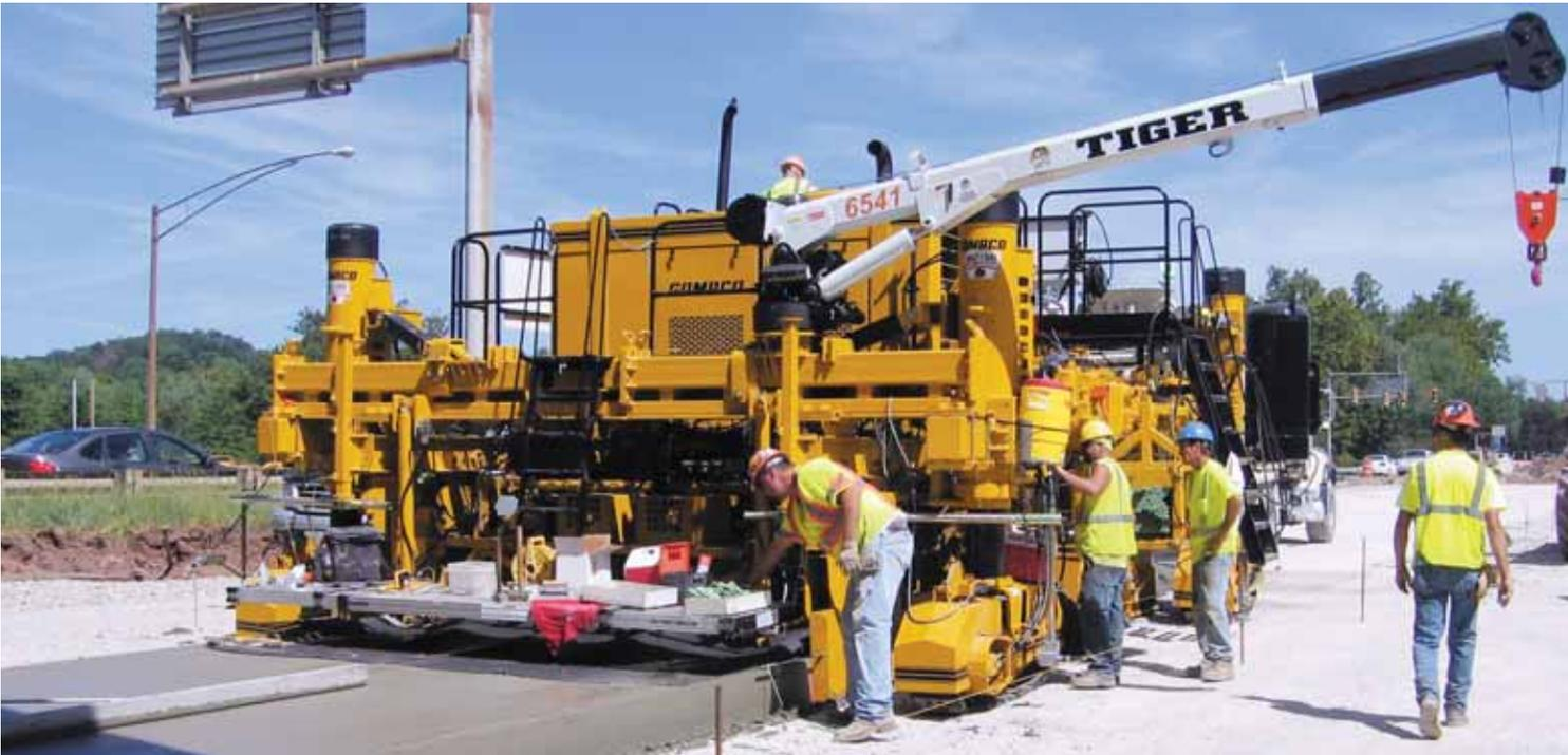
La Commander III tiene el molde serie 3100 de parte delantera abierta con sinfín y enrasadora de acero inoxidable que proporciona el acabado superior habitual de los productos GOMACO.
