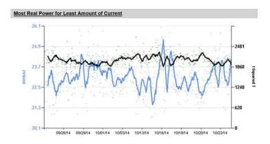
Un mauvais positionnement sur la **courbe de puissance** peut potentiellement vous coûter cher dans la mesure où la consommation d'électrode augmentera sans avantage réel sur la productivité. Le système ArchiTech vous permet de rester dans la zone de fonctionnement optimale.
