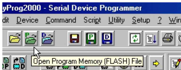
FIGURA 25: CARICAMENTO DEL FILE DA PROGRAMMARE CON PONYPROG
