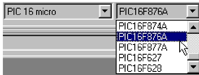
FIGURA 24: SELEZIONE DEL DISPOSITIVO CON PONYPROG
