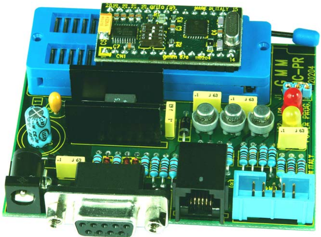
FIGURA 28: PROGRAMMATORE GMM PIC-PR CON MONTATO, SULLO ZOCCOLO ZIF, GMM 886
