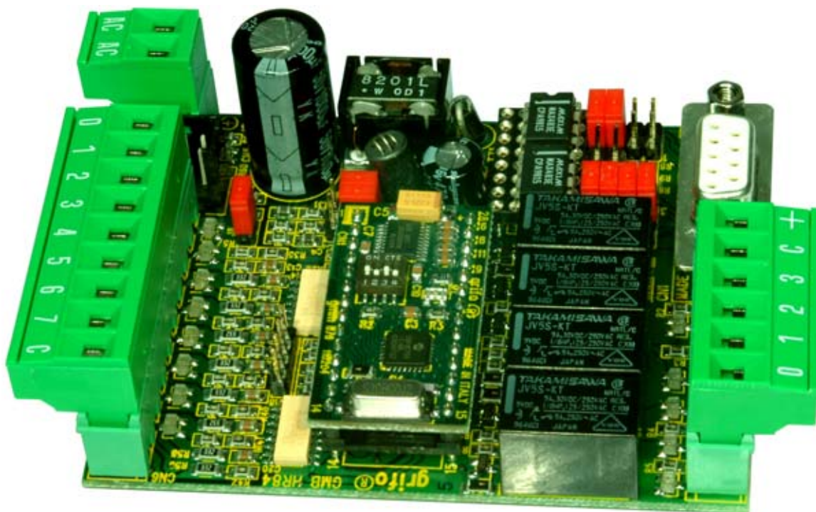
FIGURA 9: VISTA MODULO GMB HR 84 APERTO CON MONTATO UN GMM 886
