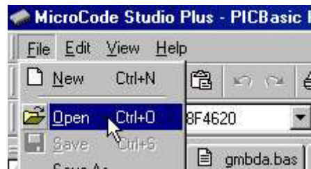
FIGURA 39: CARICAMENTO SORGENTE CON MICROCODE STUDIO + PIC BASIC PRO
