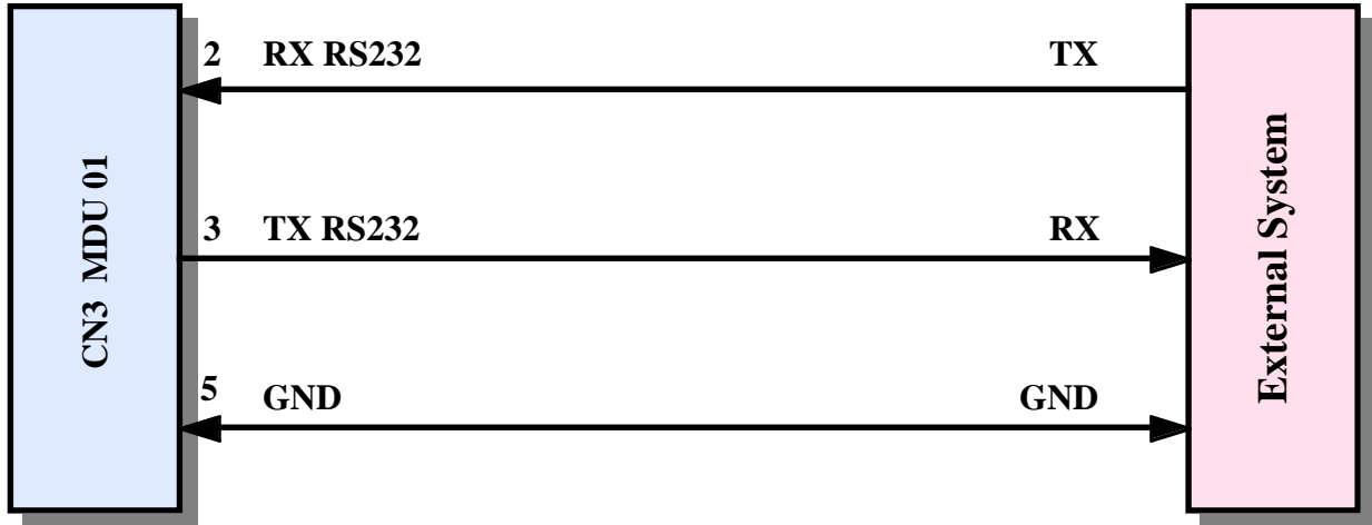
FIGURA 9: ESEMPIO COLLEGAMENTO PUNTO PUNTO IN RS 232
