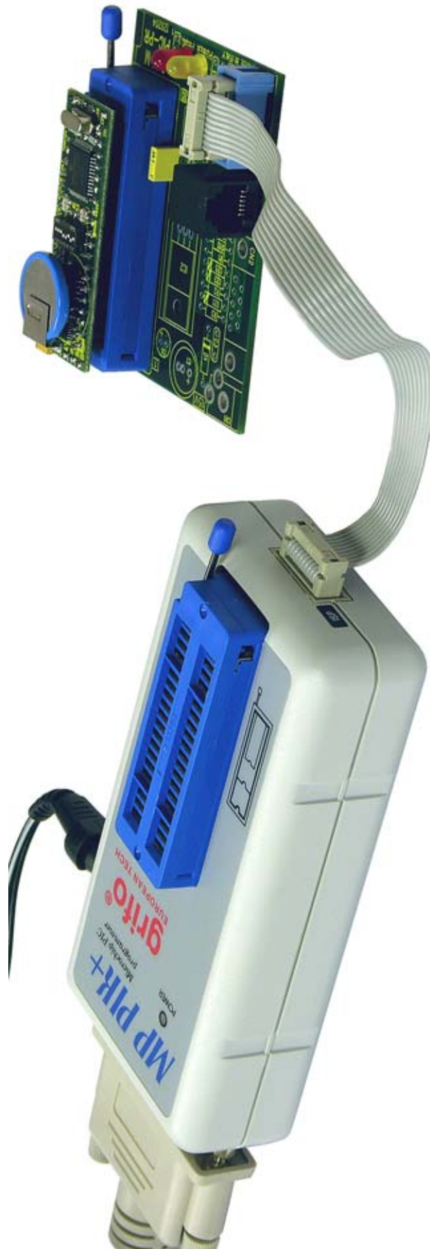
FIGURA 22: FOTO DI GMM 4620 SU GMM PIC-PR COLLEGATO A MP PIK+
