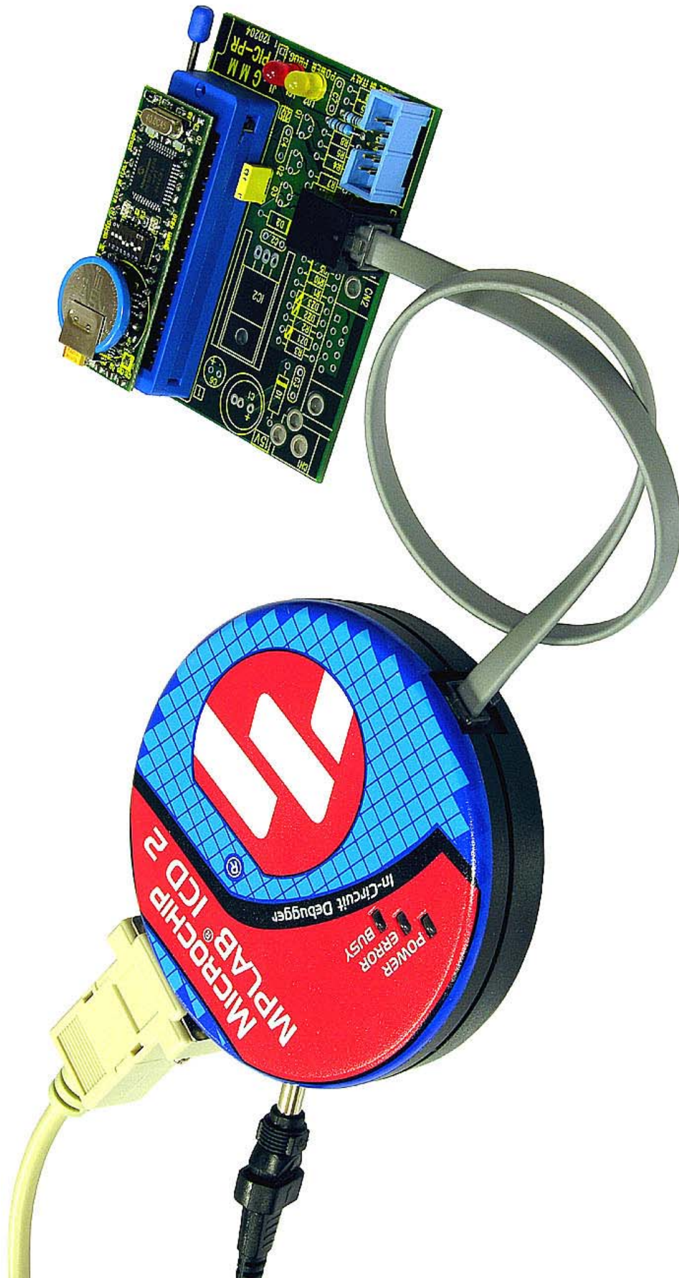
FIGURA 19: FOTO DI GMM 4620 SU GMM PIC-PR COLLEGATO A MP LAB® ICD 2
