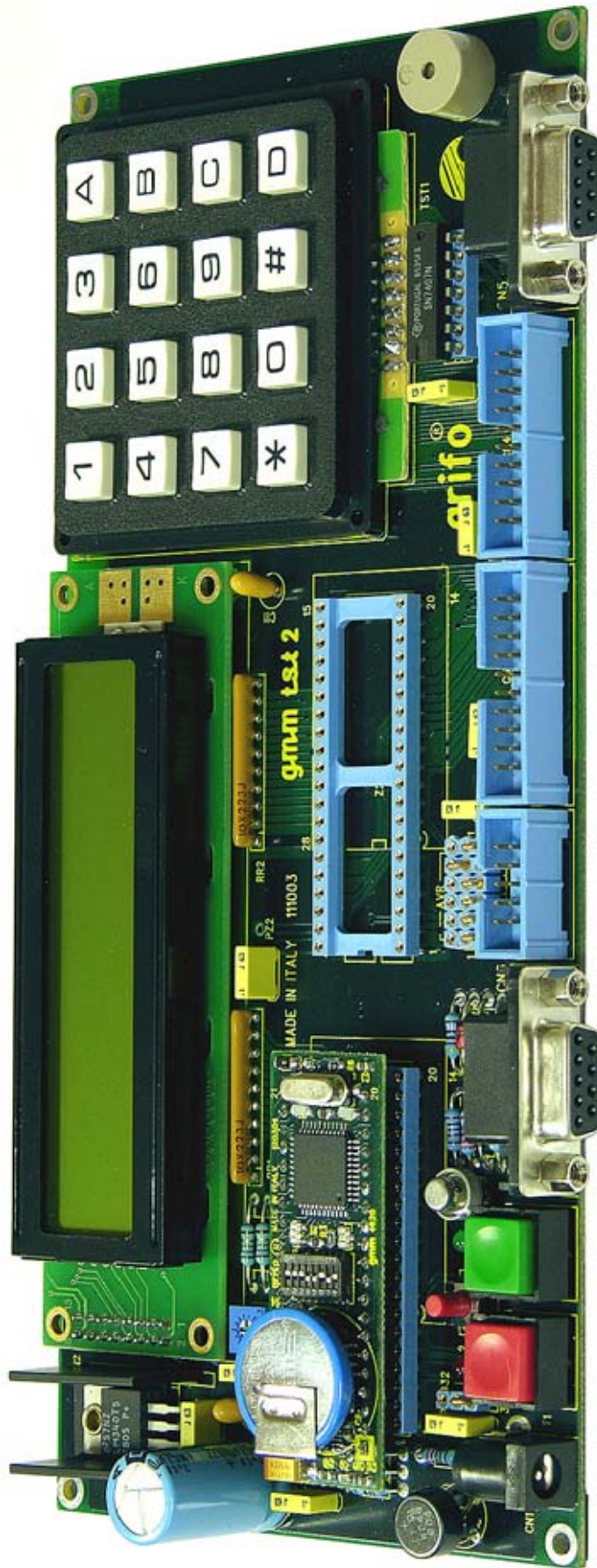
FIGURA 11: SCHEDA DI SPERIMENTAZIONE GMM TST 2 CON MONTATO UN GMM 4620
