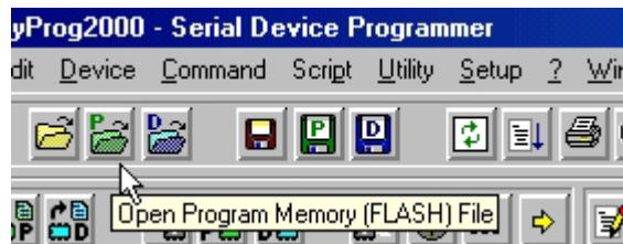
FIGURA 25: CARICAMENTO DEL FILE DA PROGRAMMARE CON PONYPROG
