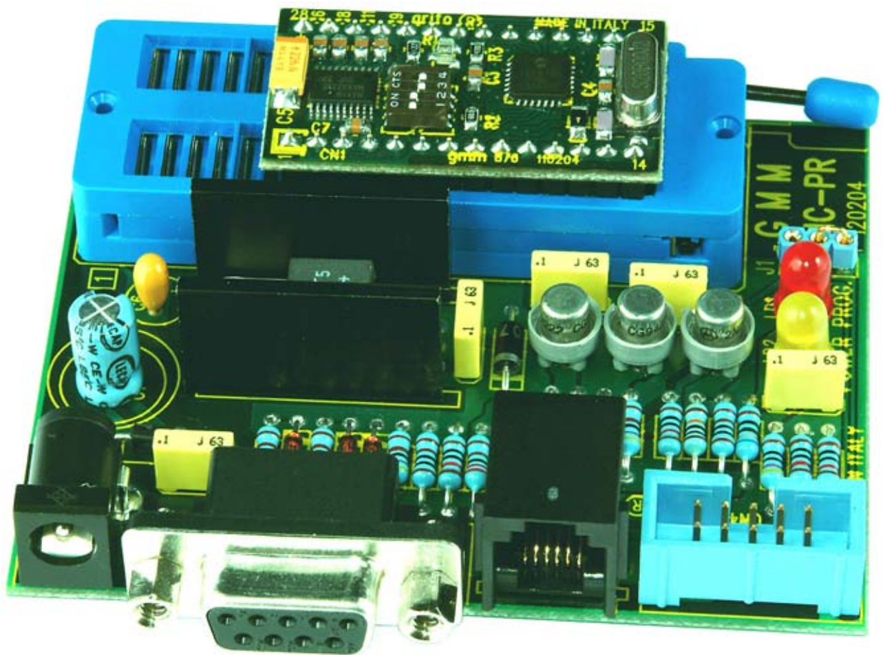
FIGURA 28: PROGRAMMATORE GMM PIC-PR CON MONTATO, SULLO ZOCCOLO ZIF, GMM 876
