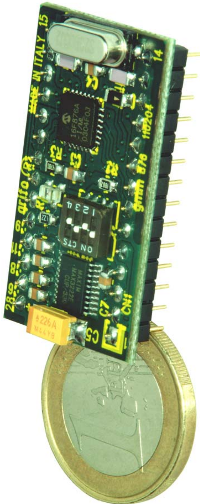
FIGURA 12: MINI MODULO GMM 876 COMPARATO AD UNA MONETA DA 1 EURO
