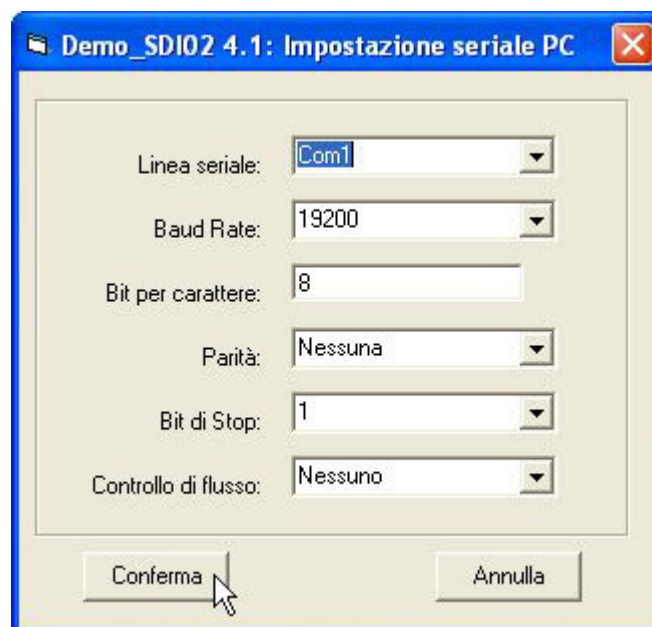
FIGURA 45: IMPOSTAZIONE SERIALE PC PER CONFIGURAZIONE CON DEMO_SDI02
