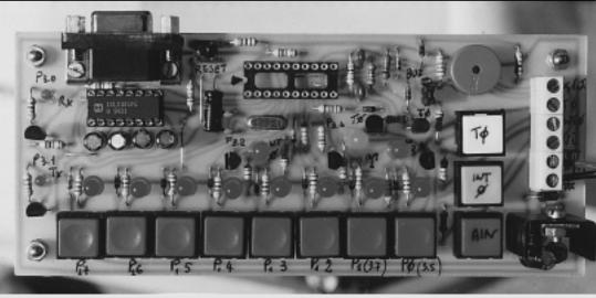
Foto 1 - Prototipo del circuito di sviluppo per 2051.
