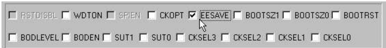
FIGURA B-16: CONFIGURAZIONE MICROCONTROLORE CON PONYPROG
