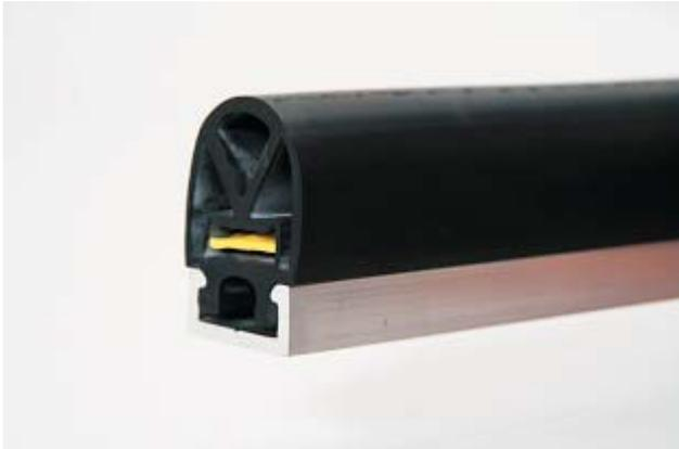
Die TS26C ist eine sehr vielseitige Schaltleiste für den Einsatz bei einer Fülle von Sicherheitsapplikationen. Sie reagiert sowohl auf Druck von oben als auch auf seitliche Betätigung. Die Schaltleiste wird in kundenspezifischen Längen angefertigt. Es kann zwischen einer flachen oder einer Winkel-Aluminiumschiene gewählt werden, dieses ermöglicht eine flexible Montage. Des weiteren ist ebenso eine flache Plastikschiene zur Montage lieferbar.
