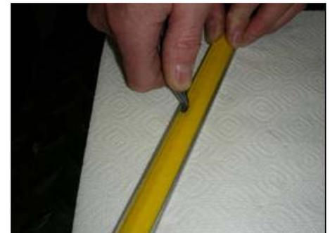
Bild 7 bis 8: Wiederholen Sie diesen Vorgang, bis der Bandschalter auf voller Länge in die Aluminiumschiene eingeschnappt ist.
