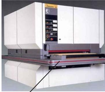
Not-Aus an Bandschleifmaschinen
