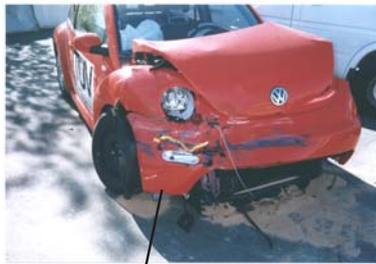
Triggerschalter für Crash Test
