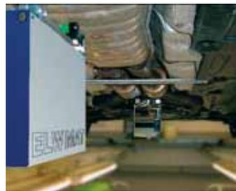
Im Gegensatz zu herkömmlichen Autokollimationsfernrohren ist der Messbereich bei gleichen optischen Parametern im Nahbereich verdoppelt. Außerdem nimmt er mit zunehmendem Spiegel-Abstand  $s$  nicht ab, sondern zu (s. Grafik ELWIMAT-Messbereiche). Der Messbereich im Fernfeld ist
