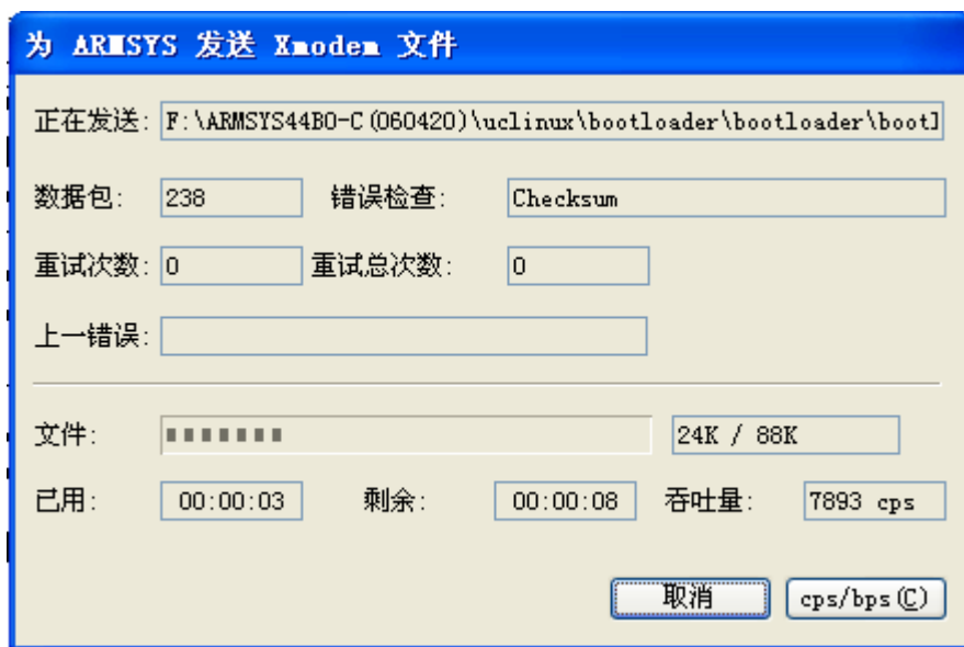
图 6-6 串口 Xmodem 传输过程
