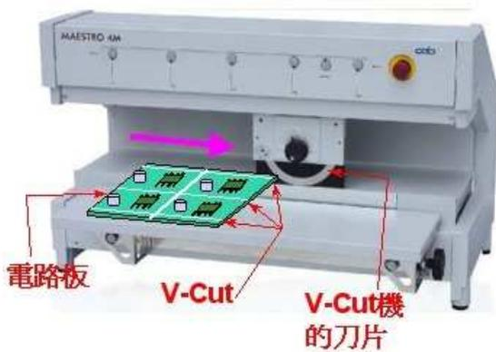
圖一： V- Cut 切割機
