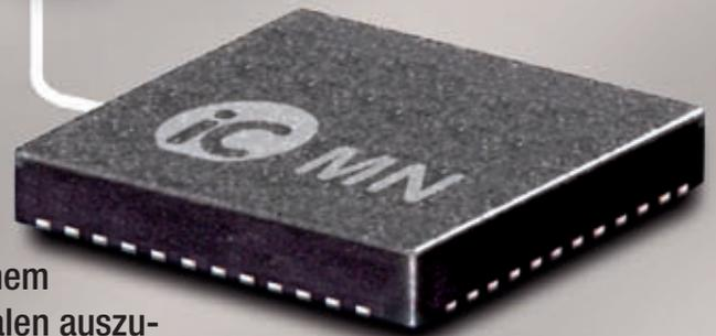
Die Interpolation analoger Sinussignale ist eine Standard-Auswertefunktion bei Positionssensoren. Mit einem speziellen Verfahren ist es möglich, mehrere Messskalen auszuwerten und zu einem Positionswert zu kombinieren. Damit sind Messsysteme möglich, die eine hohe integrale Genauigkeit oder sehr hohe Auflösungen mit guter differentieller Genauigkeit bieten. Für die Abtastung genügt ein kleiner optischer Sensor.
