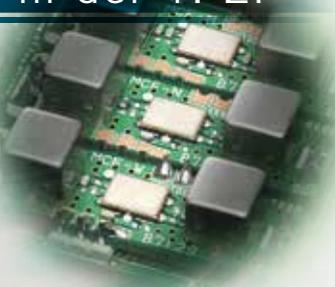
Drei eingebaute Roofing-Filter in der 1. ZF mit 3, 6 und 15 kHz Bandbreite
