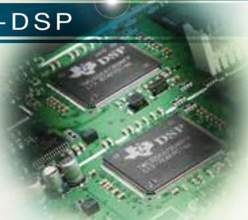
Separate DSPs für Sender/Empfänger und Spektrumskop
