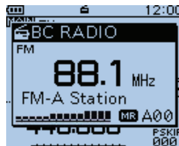
Beispiel: Display beim Empfang einer FM-Rundfunkstation der Speicherbank A
