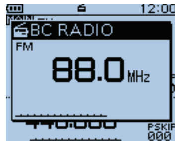
Pop-up-Anzeige bei der Einstellung einer Rundfunkfrequenz (Abstimmmodus)
