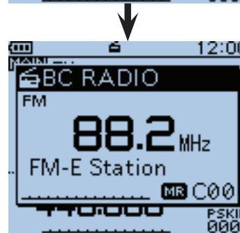
Der vorprogrammierte Speicher 00 der Speicherbank „C“ wird angezeigt.
