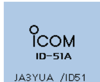
Beispiel für die Anzeige des eigenen Rufzeichens und einer programmierten Anmerkung
