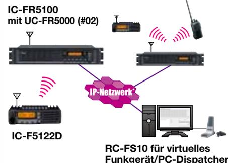
Beim Einsatz der IC-F5122D-Serie im konventionellen Multi-Site-Modus können die Nutzer mit IDAS-Funkgeräten kommunizieren, die in Reichweite anderer Repeater sind bzw. sie sind von Dispatchern des IDAS-Netzwerks erreichbar.
