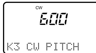
Voreingestellte CW-Pitch von 600 Hz.
