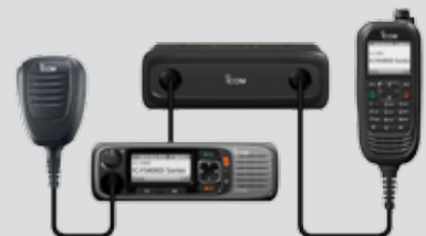
COMMANDMIC™ und abgesetztes Bedienteil* Optionales RMK-5, COMMANDMIC HM-218 und Separationskabel erforderlich
