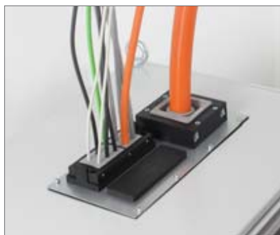
Wprowadzanie kabli przez dach szafy stosując płytę modułową. Otwór montażowy 314x144mm.
