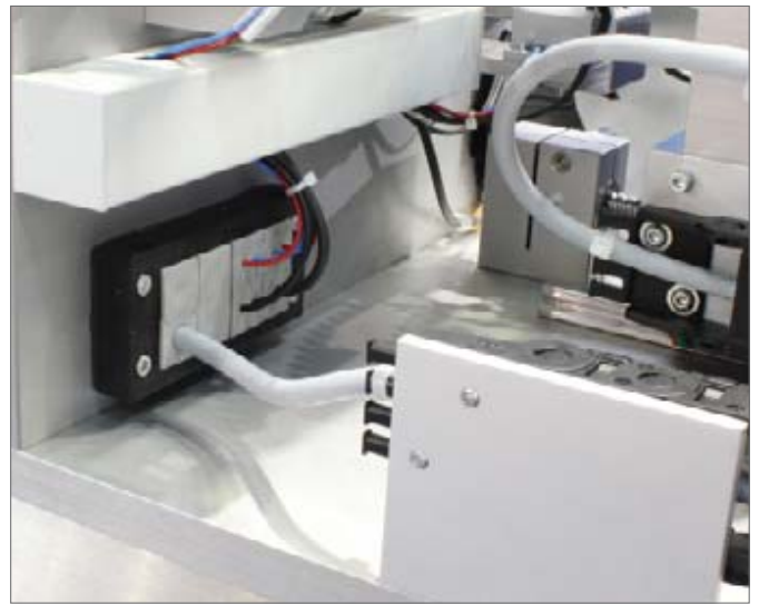
KEL 16|8 - 详见 10页 几个接头线进入到一个张力测量机的电器外壳。
