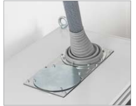
Kapalı pano tavanına modül plakaları ile sert ana hat girişi. Boşaltma ebatı 314 x 144 mm
