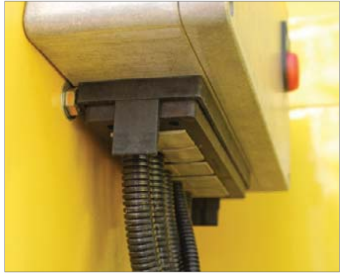
KEL-QUICK 24|10 - Sayfa 50 / KEL-SNAP 24 - Sayfa 37 Koruma hortumlarının iş makinalarında bulunan panoya girişleri.
