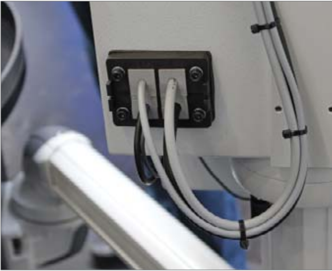
KEL-QUICK-B4 - Sayfa 51 Soketli kabloların ekran / endüstriyel bilgisayara girişi.
