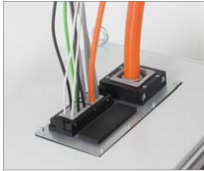
Kapalı pano tavanına modül plakaları ile kablo girişleri. Boşaltma ebatı 314 x 144 mm
