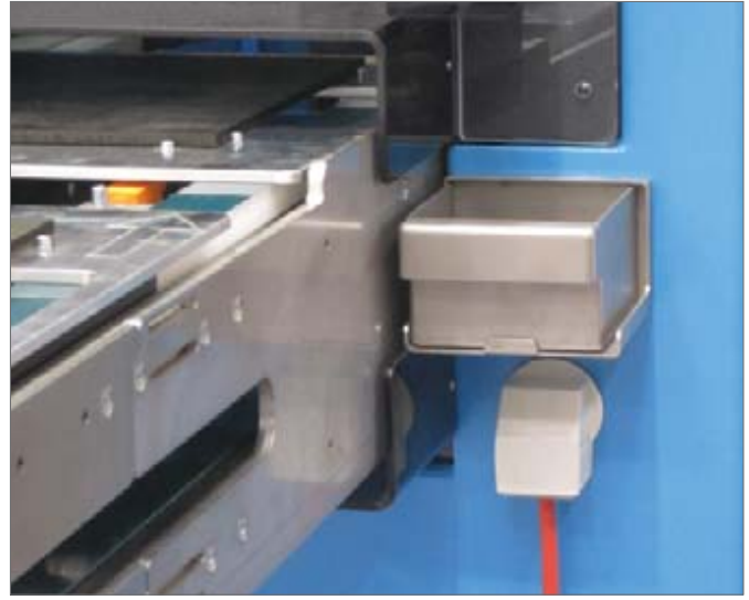
KVT 50-W90 - Sayfa 42 Kullanma paneline giden kablo, ayrılabilir açılı rakordan geçmekte.
