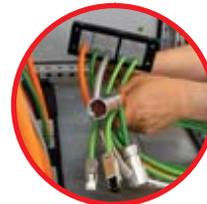
Einführung von Leitungen mit Steckern bis 35 mm Durchmesser möglich (KEL-U 24 / KEL-U 16)
