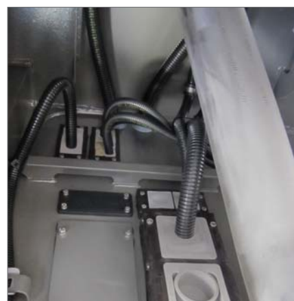
KEL-JUMBO 2 - Стр. 40 KEL 24|x - Стр. 6 Введение гофрированных труб и кабелей в раму транспортного средства.
