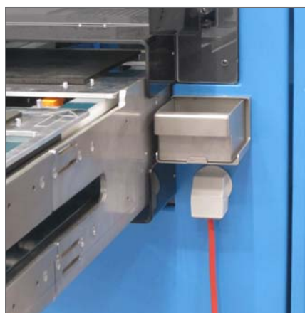
KVT 50-W90 - Стр. 28 Прокладка кабеля в панель управления под углом 90 градусов с KVT-W90.
