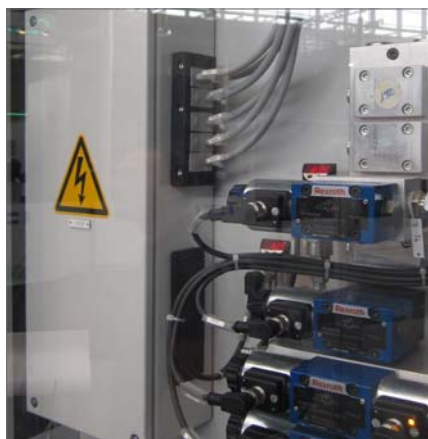
KEL 24|10 - Стр. 6 ВРК 24 - Стр. 142 Через одну секцию рамы возможно введение 6 кабелей. Другую секцию рамы возможно закрыть заглушкой ВРК 24.
