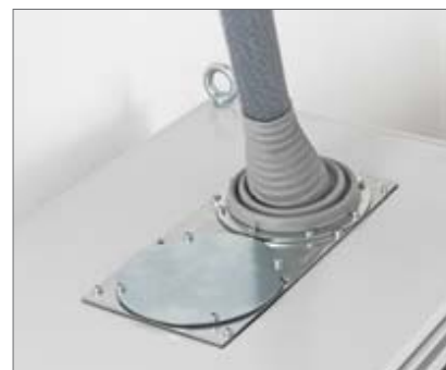
Passaggio di un cavo di alimentazione rigido attraverso il tetto di un quadro tramite una piastra modulare. Dimensioni dell'apertura 314 x 144 mm.
