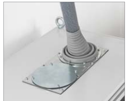
Introduction d'un câble d'alimentation rigide avec une plaque modulaire sur le toit d'une armoire. Dimension de la découpe 314 x 144mm.
