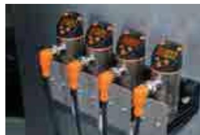
Přímé zobrazení: Dobře čitelný LED displej ukazuje aktuální systémový tlak.
