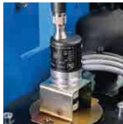
Snímání polohy čítačem: Rotační pohyb je převáděn na digitální signál.
