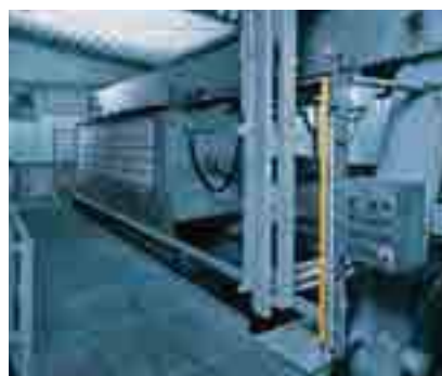
Monitorování pomocí bezpečnostních světelných mříží.
