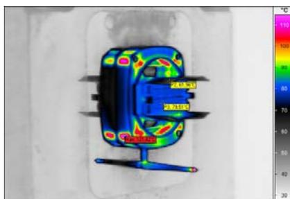
Abb. 4 Thermogramm des Formteils bei 60 °C Werkzeugtemperatur und 25 s Gesamtkühlzeit
