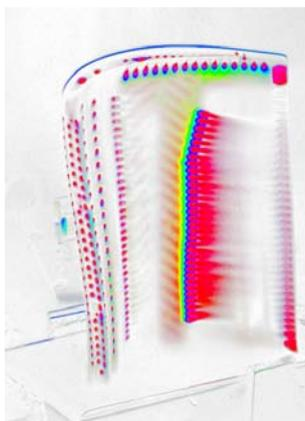
Thermografische Prüfung von Turbinenschaufeln
