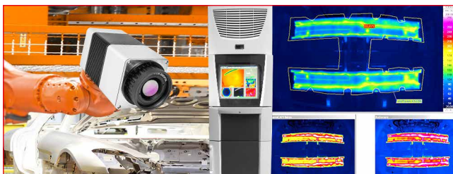
Automatisierte Überwachung des Presshärteprozesses mit PRESS-CHECK
