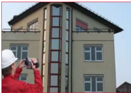
Erstellen von Thermografieaufnahmen
