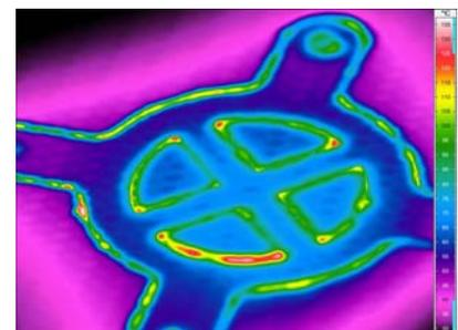
**Temperaturverteilung während des Laserstrahlschneidens eines CFK-Bauteils**
