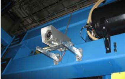
IR-Kamera 1 im Schutzgehäuse zur Messung vor dem Pressen
