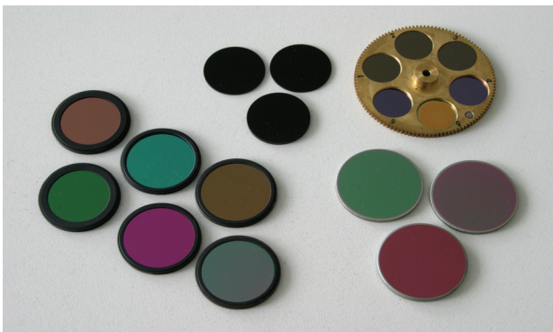
Abb. 4 Spektralfilter für Thermografiekameras
