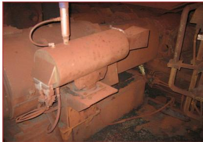
INDU-SCAN – prozessnahe Kamera-Installation: Schutzgehäuse mit Wasserkühlung und Freiblaseeinrichtung
