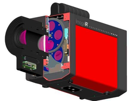
Schnittdarstellung einer Motorfokuseinheit
