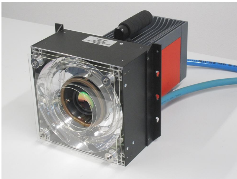
Abbildung 9: Thermografiekamera mit luftgekühlter Ringblitz-Einheit
